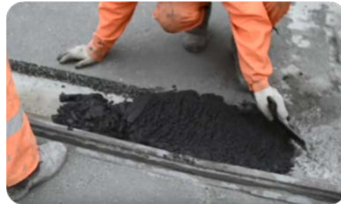
Оценка подвижности смеси российского аналога (демонстрация от производителя)
