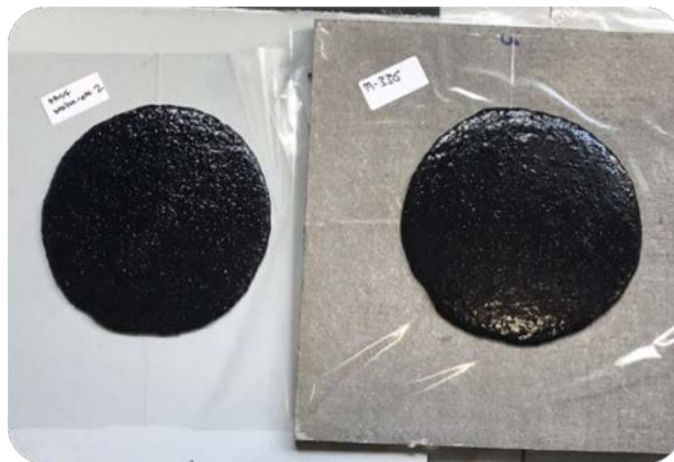
Оценка подвижности смеси российского аналога (демонстрация от производителя)
